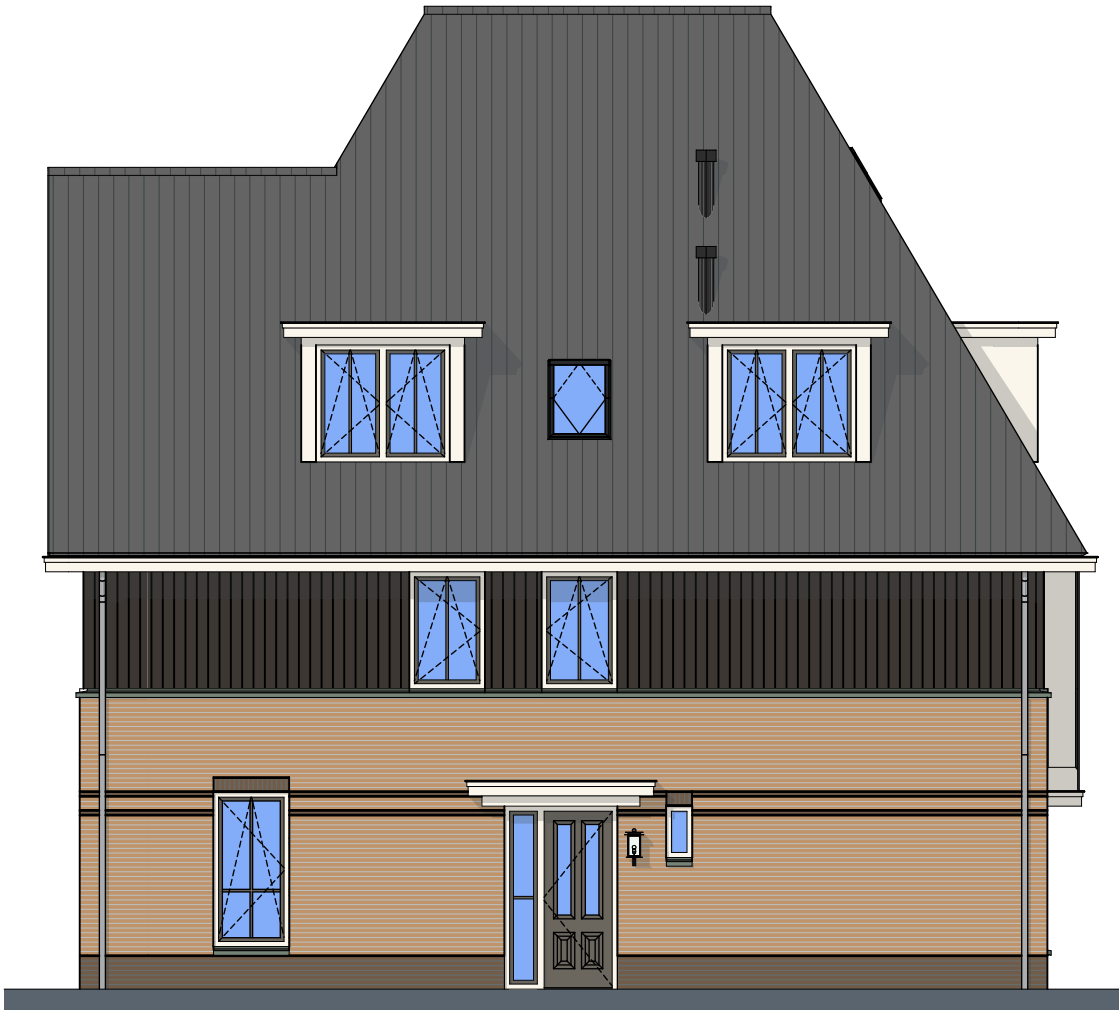
Type R2Ms C.4.01 - Dakkapel achtergevel C.4.03c / C.4.03d - Dakkapellen zijgevel
